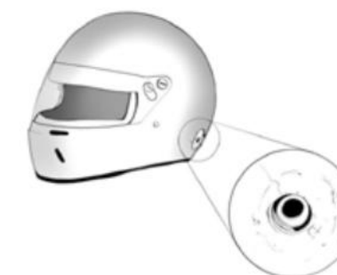
Figura 14 – Terminal M6 dañado
