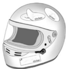
Figura 6 – Adhesivos que cubren las grietas del caparazón
